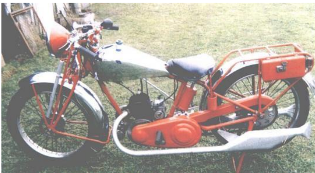
Type ER 103 moteur 175 Ravat alésage 59 course 64, 3 vitesses, 2 sortie d'échappement vendu de 1933 à 1938
