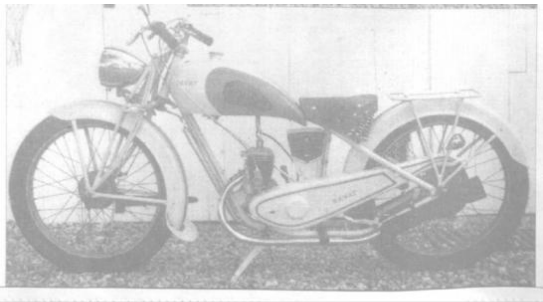
Type A37 HI moteur 100 Ravat R4, 3 vitesses vendu de 1939 à 1947 peut être 1948 (photos collection R.Lemoine)
