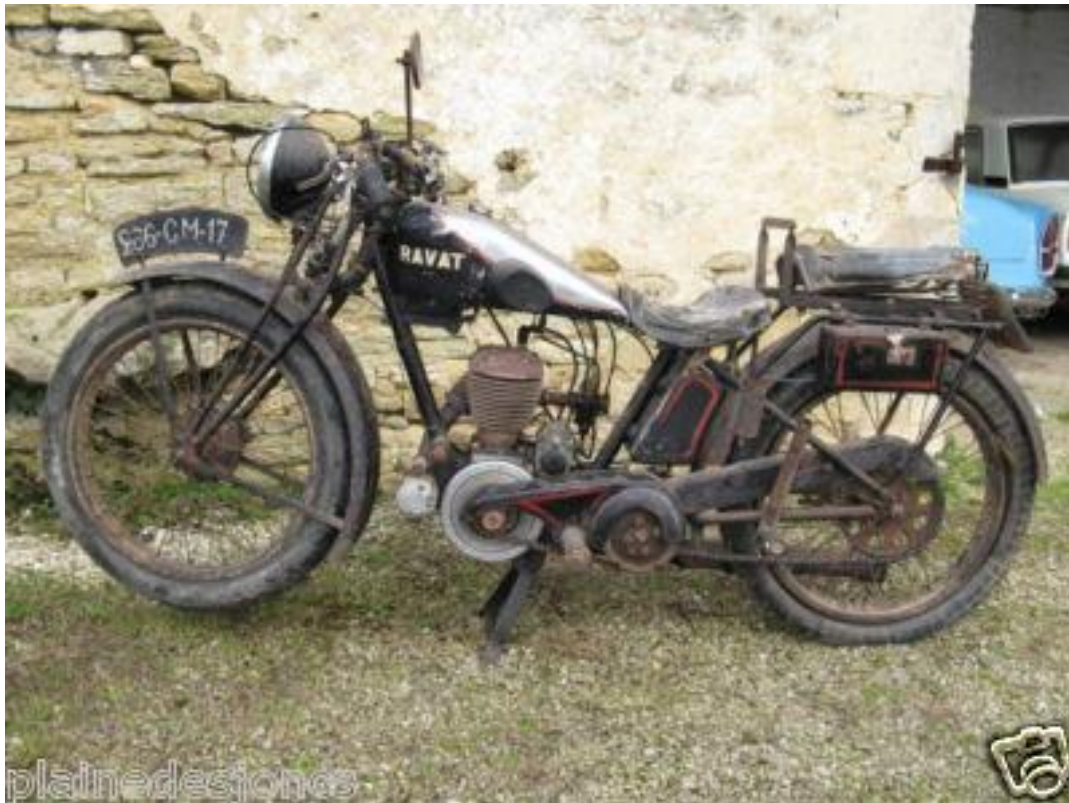
Type ER120 L moteur latérale 350 Ravat année 1934 boîte 3 vitesses, carburateur Amac modèle vendu de 1933 à 1938 (photo trouvé sur internet le propriétaire peut me contacter)
