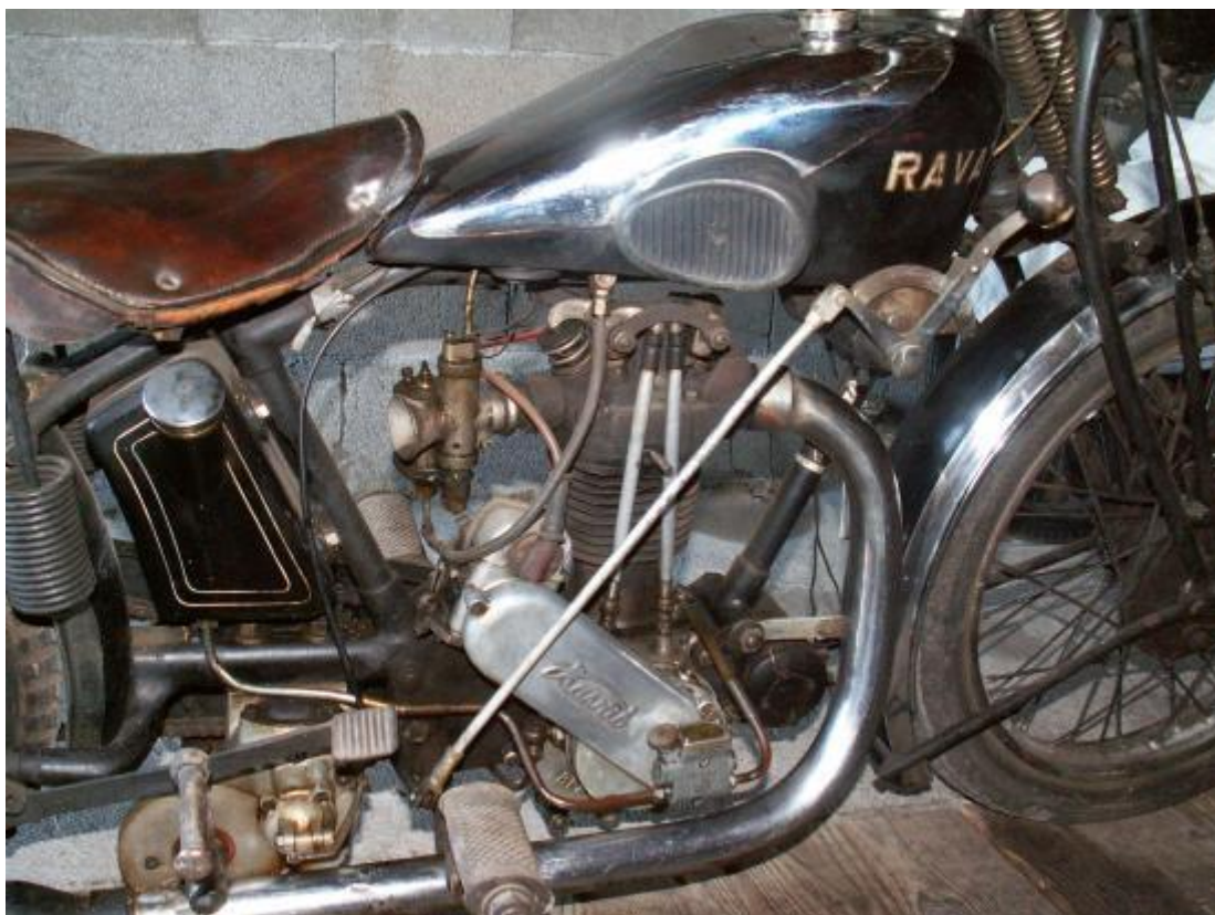
Type ER120 L moteur latérale 350 Ravat année 1934 boîte 3 vitesses, carburateur Amac modèle vendu de 1933 à 1938 (photo trouvé sur internet le propriétaire peut me contacter)
