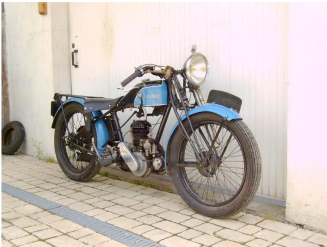
Type ER 102 moteur 175 Ravat alésage 59 course 64, 2 vitesses carburateur Amac vendu de 1933 à 1936
